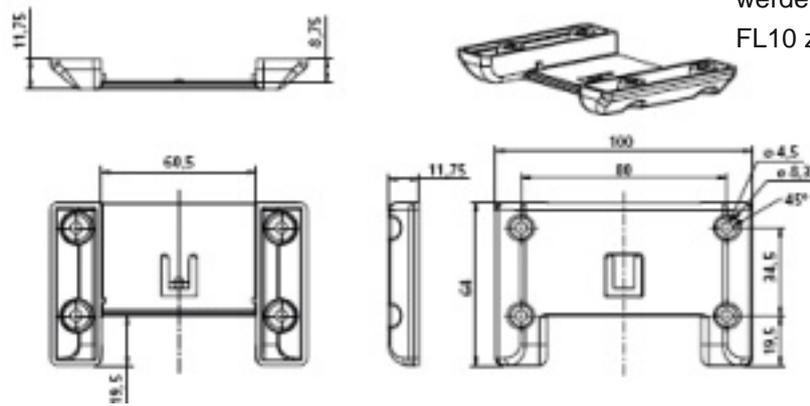
Diese Abdeckung kann ergänzt werden, wenn die FLC CB7 und der FL10 zusammen montiert werden.
